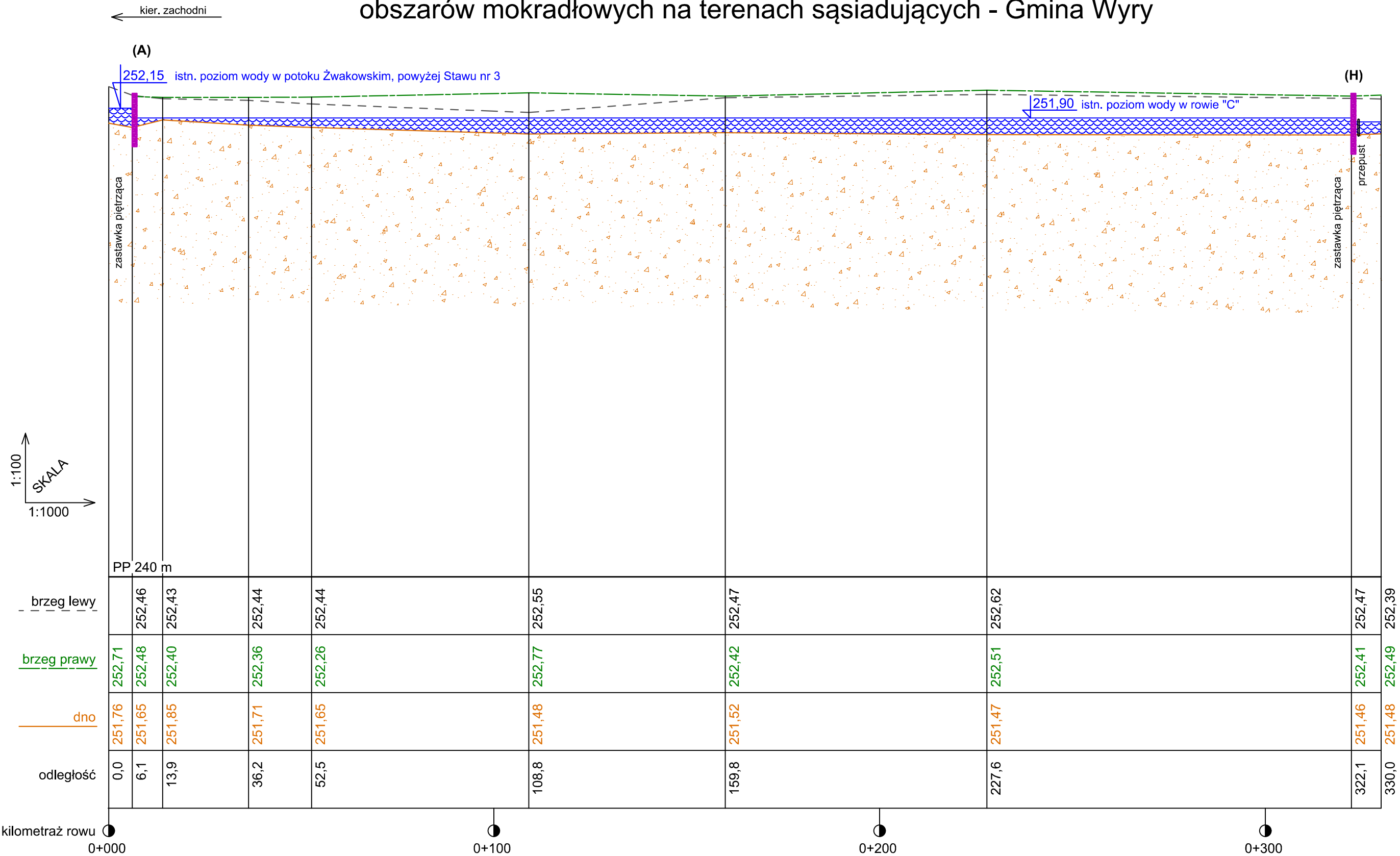
Profil podłużny rowu "C" Skala 1: 100 / 1000 Rysunek nr 2.5
